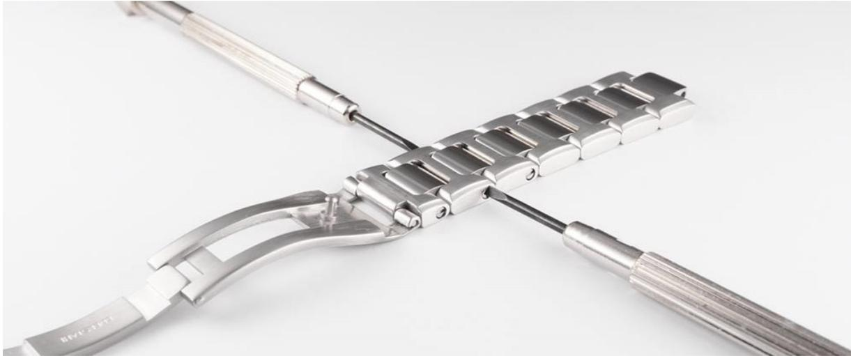
Diese Schraubendreher setzen Sie links und rechts jeweils an der Schraube des zu entfernenden Bandteils an.
